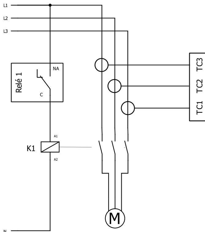
**Para cargas superiores a 5A fazer uso de contator elétrico.**
